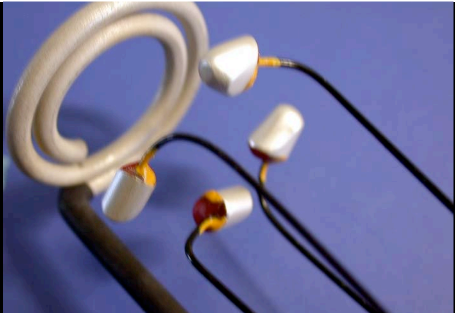
Die Primärteile im Galvanokopf positioniert
