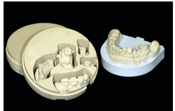
Abb. 15: Bei vFM Dentallabor gefrästes Modell aus der gipsbasierten 3D modeldisc von dentona.
