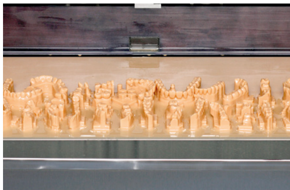
Abb. 10: Herstellung von Dentalmodellen bei Dreve (Bildquelle: Dreve).
