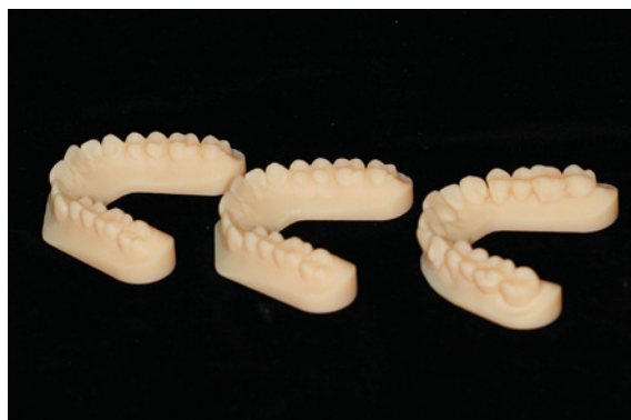
Abb. 17: Mittels Polyjet-Modeling erstellte Modelle für die Schienentherapie.
