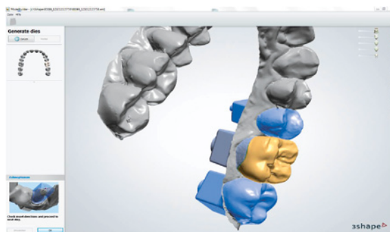
Abb. 5: Planung von herausnehmbaren Stümpfen mit Rotationsschutz im ModelBuilder.
